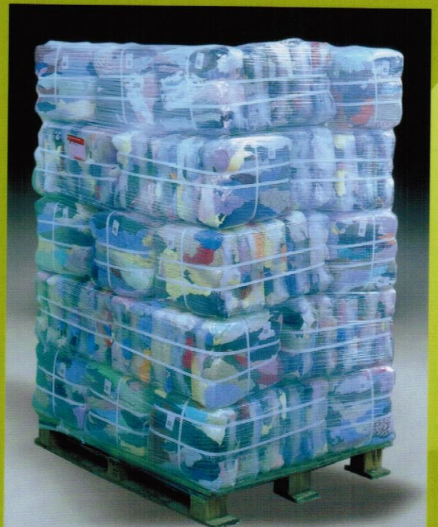
PRODUCTO TERMINADO: codificado, retráctilado y paletizado
